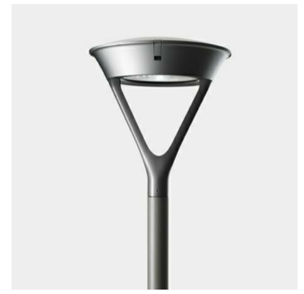
LÚ2: LED Hattur með samhverfum ljósgeisla sem lýsir niður Eiginleikar: 4000K, ~500lm, CRI 70, IK10, IP66 Viðmiðarlampi: iGuzzini BM33
