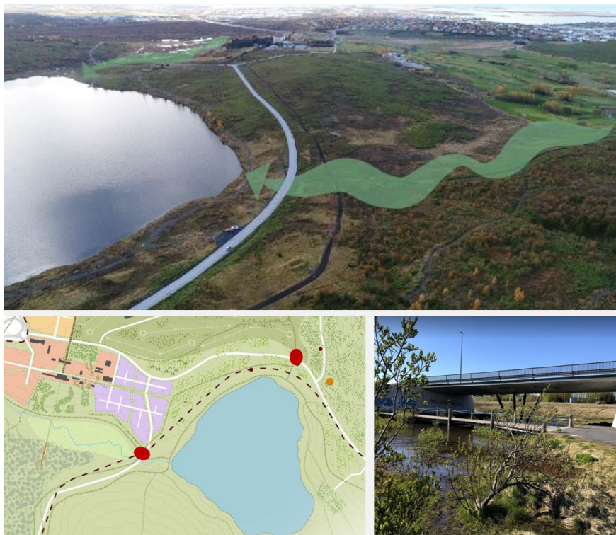
MYND 50 Efri röð: flugmynd af Vífilsstaðavatni og nágrenni horft til suð-vesturs, rauður hringur er utan um svæði þar sem breytt lega Elliðavatnsvegjar/Flóttamannavegar skapar rýmd fyrir undirgöng þar sem náttúra og stígar ná að flæða óhindrað og tengja byggð við útvistarsvæði umhverfis vatnið. Neðri röð til vinstri: úrklippa úr skýringarmynd sem sýnir staðsetningu undirganga. Neðri röð til hægri: Ástjörn í Hafnarfirði þar sem náttúra og stígar fá að flæða óhindrað undir umferðamannvirki.
