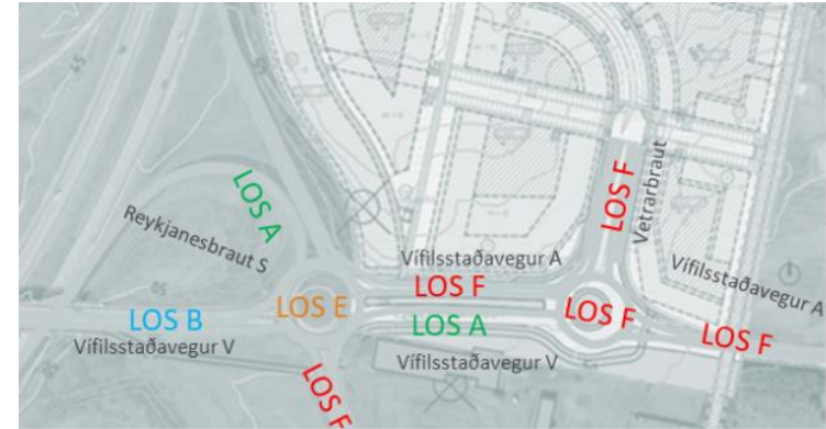
LAUSN B: Einfalt hringtorg á gatnamótum Vífilsstaðavegar – Vetrarbrautar, með hægri beygju framhjálaupi. Einfalt hringtorg við Vífilsstaðaveg – Reykjanesbraut.
