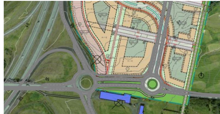
Lausn C: Tvöfalt hringtorg á gatnamótum Vífilsstaðavegar – Vetrarbrautar, með hægri beygju framhjáhlaupi. Tvöfalt hringtorg við Vífilsstaðaveg – Reykjanesbraut.
