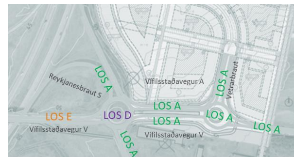
LAUSN B: Einfalt hringtorg á gatnamótum Vífilisstaðavegar – Vetrarbrautar, með hægri beygju framhjálaupi. Einfalt hringtorg við Vífilisstaðaveg – Reykjanesbraut.
