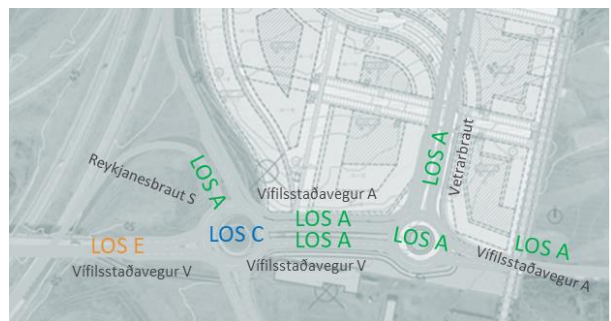
LAUSN C: Tvöfalt hringtorg á gatnamótum Vífilisstaðavegar – Vetrarbrautar, með hægri beygju framhjálaupi. Tvöfalt hringtorg við Vífilisstaðaveg – Reykjanesbraut.
